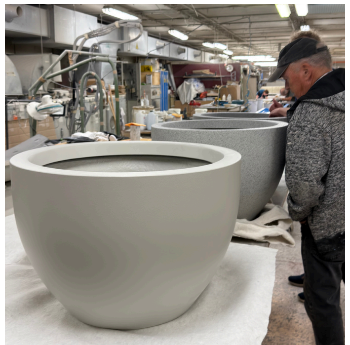
Spezialanfertigung Topcoat Sichtbeton Grau
